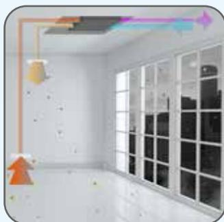
Il rinnovo con VMC (Ventilazione Meccanica Controllata) con recupero passivo permette il rinnovo dell'aria e un recupero dell'energia termica o frigorifera in essa contenuta con efficienze energetiche medie.
