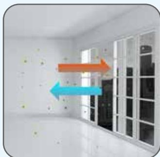
Negli ambienti confinati con un impianto di climatizzazione privo di ventilazione meccanica controllata, il rinnovo dell'aria viene effettuato con l'apertura delle finestre. Ciò non consente la filtrazione dell'aria e comporta una riduzione del comfort oltre ad un notevole spreco energetico, soprattutto nelle stagioni invernali ed estiva.
