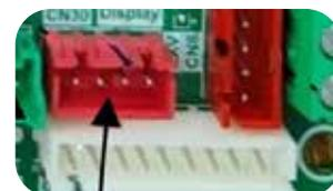
Pour utiliser la boîte d'affichage, il suffit de la brancher sur le connecteur CN30 de la carte de l'unité intérieure.
