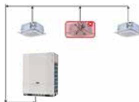
Réfrigérant accumulé dans l'ODU
