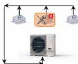
Réfrigérant accumulé dans l'ODU
