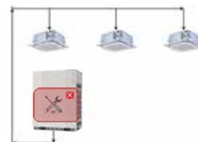
Réfrigérant accumulé dans les UDI
