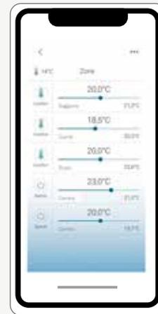
Verwaltung von 12 unabhängigen Zonen, für die jeweils die Möglichkeit besteht, die Temperatur zu ändern und die Energiesparfunktion einzustellen, außerdem können die Zone einzeln aus- und eingeschaltet werden
