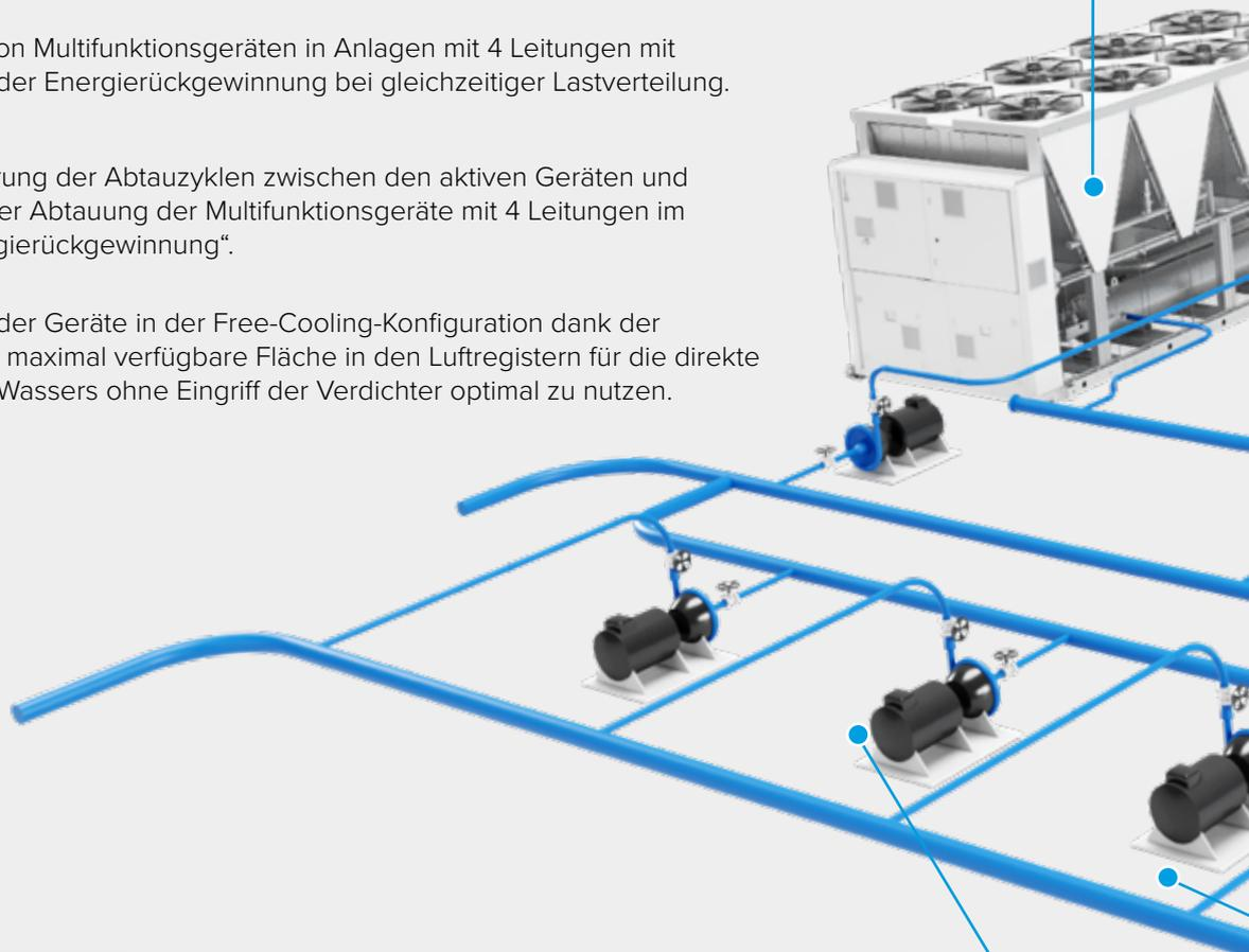
INTELLIPLANT verwaltet die auf der Quellseite vorhandenen Geräte am besten, indem die Lösung Temperaturen, Drücke und Wasserdurchfluss reguliert, damit die Heiz-/Kühlgeräte mit maximaler Effizienz betrieben werden können.
