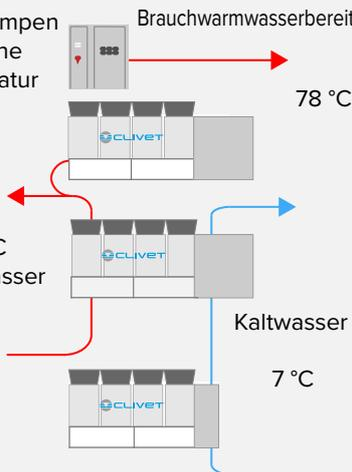
Gleichzeitige und unabhängige Produktion von Warm- und Kaltwasser, Warmwasserbereitung mit hoher Temperatur (Brauchwasser)
