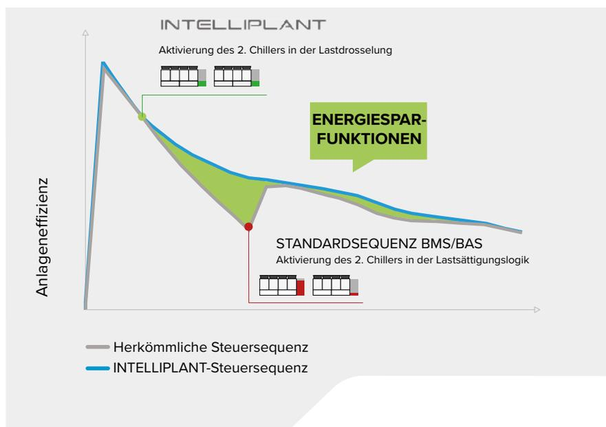
In dieser Simulation steuert INTELLIPLANT 2 luftgekühlte Chiller mit Schraubenverdichter, davon einen mit Invertertechnologie, für eine Gesamtleistung von 1,5 MW.
