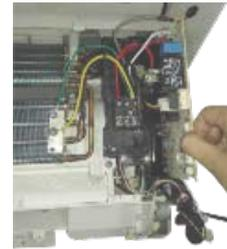
EINFACHE ENTNAHME DER PLATINE
