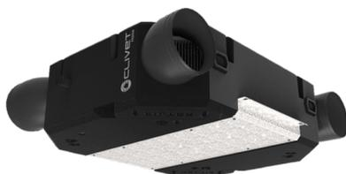
Unità interna dotata di ventilatore di immissione dell'aria di rinnovo, ventilatore espulsione dell'aria viziata, sistema filtrante, recupero di calore termodinamico e compressore rotativo DC inverter
