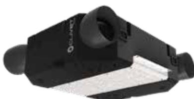
Unità interna dotata di ventilatore di immissione dell'aria di rinnovo, ventilatore espulsione dell'aria viziata, sistema filtrante, recupero di calore termodinamico e compressore rotativo DC inverter
